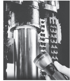
(写真2) シリンダOリングからの漏れを発見
