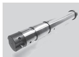
同製品はエンジン部品であるシリンドラブロックのクランク穴を仕上げる長尺ボーリングホルダである。近年、汎用機仕様のツールが設定されているが、高価な専用の支持治具が必要となり、設備投資の面で不利である。同製品の流体軸受けセルフサポートにより、上記専用治具は不要となり、安価な汎用ツーリングを提供することが出来る。
