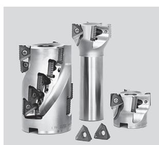
肩削り加工は、工具軸に対して曲げ方向に大きな切削抵抗を受けるため、びびりが発生しやすい加工の一つである。そのため、特に重切削条件下では、高能率加工がおこなえなかった。この対策として、従来よりニック付インサートを用いた加工があるが、低抵抗化には限界があった。
