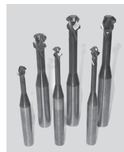
この開発は、小径面取り工具に千鳥刃を採用し表面・裏面共に加工時のビビリや2次バリを抑制して工具の長寿命化並びに、加工品質向上を図ったものである。
