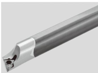
一般的に穴繰り加工では最小加工径φ20mm以上で両面仕様インサートが適用されているが、実際には加工径φ10mmからφ20mmが主流であり、この領域における工具費低減を目的に最小加工径φ12mmからを両面仕様インサートで使用可能な経済性に優れる穴繰り工具を開発した。穴繰り加工に要求される切削性能としては、耐びびり性および切りくず排出性に優れることである。
