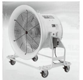
「SJF-604A」は、スイデンの新技术で、風の流れをスムーズにする拡管構造である『VF DESIGN』により余分な旋回流(風の渦)をなくし、スムーズな風の流れを生み、従来機比10dBの低騒音化と最大23%の省エネ化を実現した。(3相200V 50Hz時)
