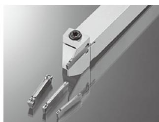
GND型はホルダ材質に高剛性の特殊鋼を採用、チップ固定部からシャンクまでを一体構造とし、加工中に発生する振動を従来品比で最大30%低減。通常の溝入れ加工に加え、横送り加工、プロファイ尔加工、突切り加工を可能にする工具である。
