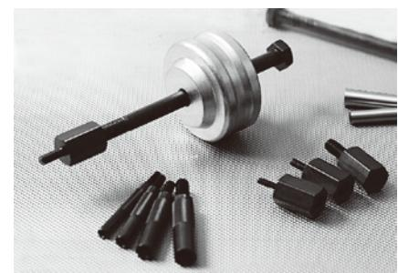
オーエッチ工業の小型部品の引き抜きツール「ショートスライドハンマー」が好評を得ている。小型部品引抜きツールは、金型をプレスや成形機にセットしたままでも使用できるショートストローク設計。プレス・樹脂金型、機械修理やメンテナンス時に必要となる、部品位置決め用のテーパーピン・ノックピンの引き抜きに使用、また、ネジ穴のあるイレコも引き抜ける。
