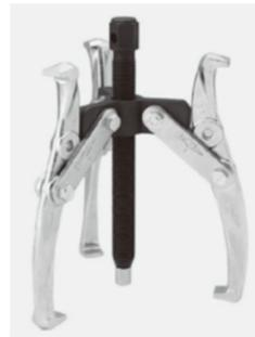
爪の穴を2つにすることで、爪の届く範囲(80ミリ〜)が拡大した。さらに長爪に付け替えれば、さらに使用範囲が広がるという。機械、自動車修理の解体修理で実績を伸ばしている。
