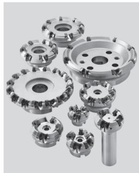
主な特長は、①独自開発「両面Z形状」ネガティブインサートにより、低抵抗を実現し切れ味やびびり振動を抑制。②切りくずはつるまき状に排出されるように設計され、切りくずの噛み込やカッタボディへの擦過を防止。③円錐型をした着座は、飛散防止(A.F.I)機能と共にインサートの着座面積を確保しながら万が一の突発欠損時でも着座損傷やカッタボディへの擦過損傷を抑制。
