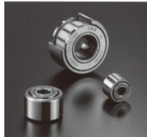
ローラフォロアは、厚肉の外輪にニードルローラを組み込んだ外輪回転用に設計されたベアリングで、カム機構や搬送装置の直線運動部分のガイドに広く使用されている。
