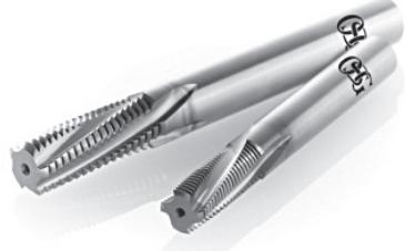
従来スレッドミルでの加工は、倒れが原因となって加工時間がかかることが課題となっていた。そこでオーエスジーは、従来の右刃右ねじれに対し「右刃左ねじれ」仕様を採用することで、口元と奥側との有効径差を小さくし、ゲージアウトが遅い。また、シャンク部側（口元）から加工が始まるため、倒れの少ない加工を可能とし、倒れ補正のゼロカットも不要。2パス加工から1パス加工へ。びびりについても不等分割・不等リードにより解決など、加工時間の削減と共に長寿命化を実現した。
