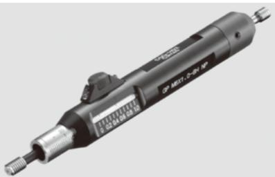
専用ねじゲージおよび下孔用栓ゲージを使用することにより深さ測定範囲が広がる。深さ読み取りが0.1mm単位で読み取ることができる。通りゲージのみの注文にも対応。標準在庫のねじゲージを使用できるため即納対応となっている。
