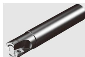
同製品は中仕上げ加工領域において、生産性の高いフライス加工領域を実現する汎用性の高いコンセプトカッター。エンドミルの高精度加工を実現する、07mmサイズの切れ刃を持つ刃先交換式エンドミル。一本で様々な加工領域（正面フライス加工、プランジ加工、肩削り加工、フル溝加工、ランピング及びヘリカル加工）に対応する万能工具である。
