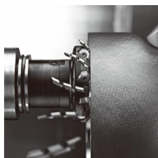
通常軸方向、径方向ともネガのカッターは、両面チップが使える利点はあるが、切り屑つまり、高い動力、大きな切削音が問題となる。「コロミル745」は両面チップでありながら、これらの問題を解決した画期的な14コーナマルチエッジ正面フライスカッターである。特に小型、中型マシニングセンタでは両面チップのこれらの問題点によって、その生産性が制限されてしまう。「コロミル745」は切れ刃傾き角をポジに大きくとることと(ネガ・ポジカッターコロミル245と同じ傾き)、シャープな切れ刃によって、つるまき状の切りくず(カッターから外側に排出される)、切れ味のいい切削、静かな切削音がネガ・ネガカッターにも関わらず可能となる。さらに、低い動力で加工できるため小型マシニングセンタにおいて、切込みを大きくし大幅にサイクルタイムを低減できる。
