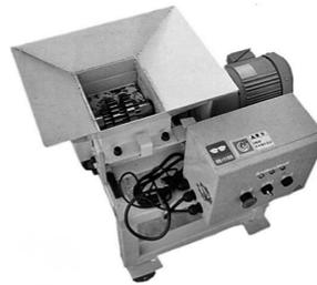
【特徴-2】センサーとシーケンサーを用いて、常に稼働状況を監視。サーマルのみのタイプに比べ、確実にギヤモーターを制御。ギヤモーターの焼付け、破砕刃過剰負担を防止する。
