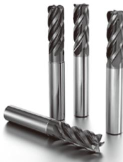
不等ピッチによりびびりが少ない安定した加工を実現し、特殊な刃先処理により切削アクションも軽快。荒加工に最適化されたフルート設計と、様々な被削材に対応できる新材種の組み合わせで、高いテーブル送りを実現する。更に内部クーラント供給するタイプも備え、ユーザーの状況に合わせたラインナップを図る。
