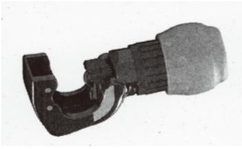
ロボテックスは、「バリの出にくいチューブカッター」を製品化、ターゲットユーザーを絞り込むことで適用パイプ範囲を限定し、パイプに特化した極薄刃を採用。バリの大きさを従来品比で約50%削減した。
