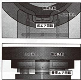
ロボットやローダによる無人運転をする場合、ストッパ上でエア検知を行いワークの密着確認をするチャッキングデザインが一般的となっているが、同社では、更に無人運転でのチャッキングミスを防ぐのを目的に同製品を開発した。これにより、FA生産ラインのネックになっていた爪部への切屑付着によるチャッキングミスを解消し、不良率を低減させるユーザーニーズに応えている。
